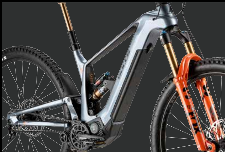
Carbon-Rahmen mit Aluminium-Hinterbau
